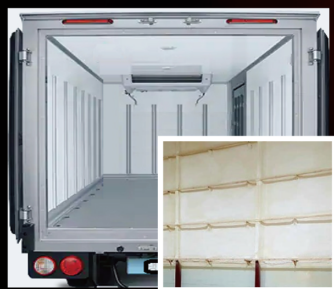
■ 結露防止・省エネ (冷凍車 / 3mm 断熱施工)
